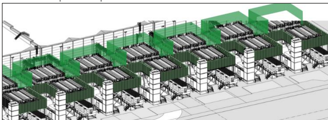
Figure 6: Vue 3D de l'écran acoustique
